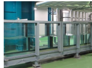
2次元造波水槽
